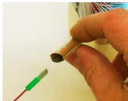
5. Den elektrischen Anzünder in 3-4 cm Abstand einführen.
