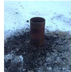
Metallmörser zu 2/3 vergraben
