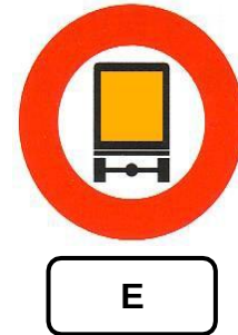
Abb. 5: Signalisation «Tunnel mit Beschränkung»
