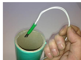
Führen Sie den elektrischen Anzünder mit den Blackmatch Stücken ein.
